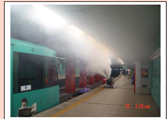
Heißrauchversuch in einer U-Bahn-Station
